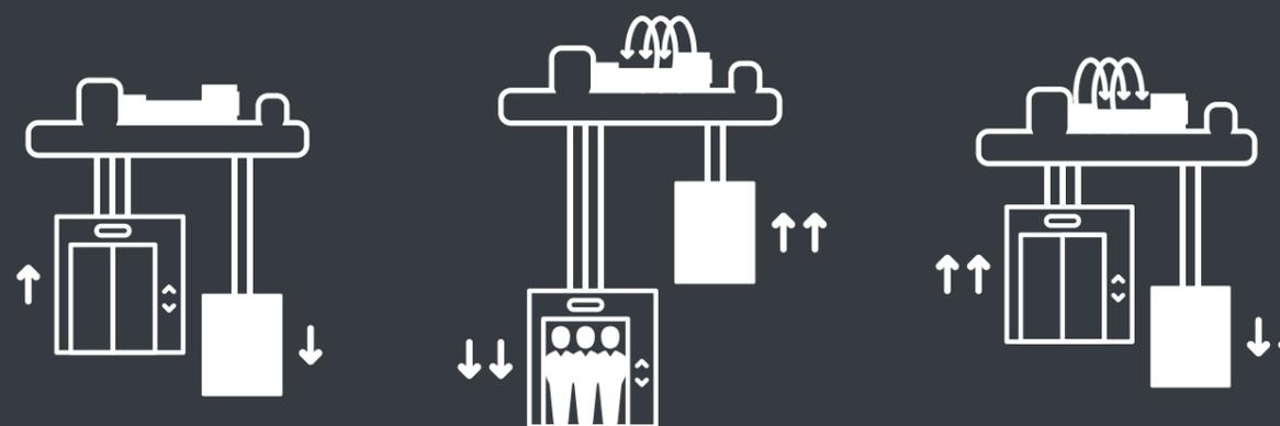
En un ascensor la cabina está unida a un contrapeso a través de una polea. Cuando el contrapeso baja, la cabina sube, y cuando el contrapeso sube, la cabina baja.
