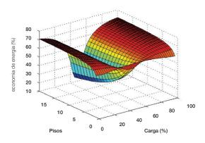
Economia de energia com o equipamento ReGen® em comparação ao equipamento não-regenerativo, em função da carga dentro da cabina e quantidade de pisos (de 1 a 20).
